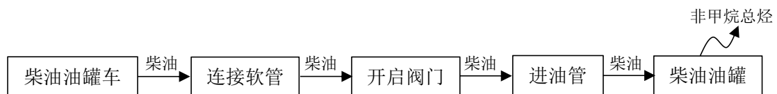
图 2-4 柴油卸油工艺流程及产污环节图
